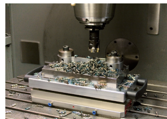
Bridage double avec plaque de bridage
